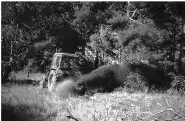
Рис. 2. Прокладка минерализованной полосы с засыпкой грунтом трактором МТЗ-82 («Беларусь») с лесопожарным фрезерным агрегатом АЛФ-10
