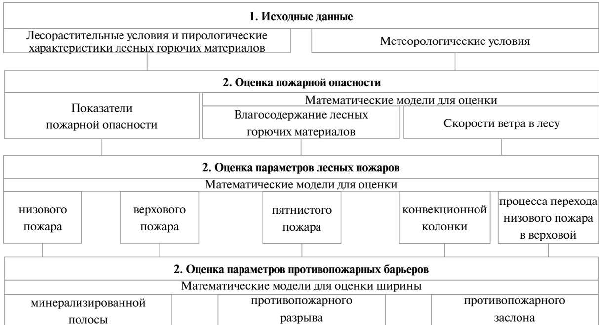
Рис. 1. Блок-схема системы согласованных математических моделей для оценки параметров лесных пожаров и противопожарных барьеров
