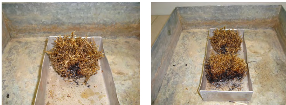
Рис. 3. Образцы зелёного мха, обработанные раствором универсального ОС, после огневого воздействия
