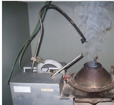
Рис. 3. Интенсивное испарение влаги при высокоинтенсивном тепловом воздействии на образец ЛГМ
