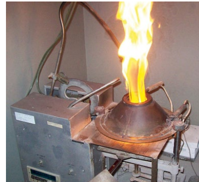
Рис. 4. Воспламенение образца ЛГМ при воздействии теплового излучения
